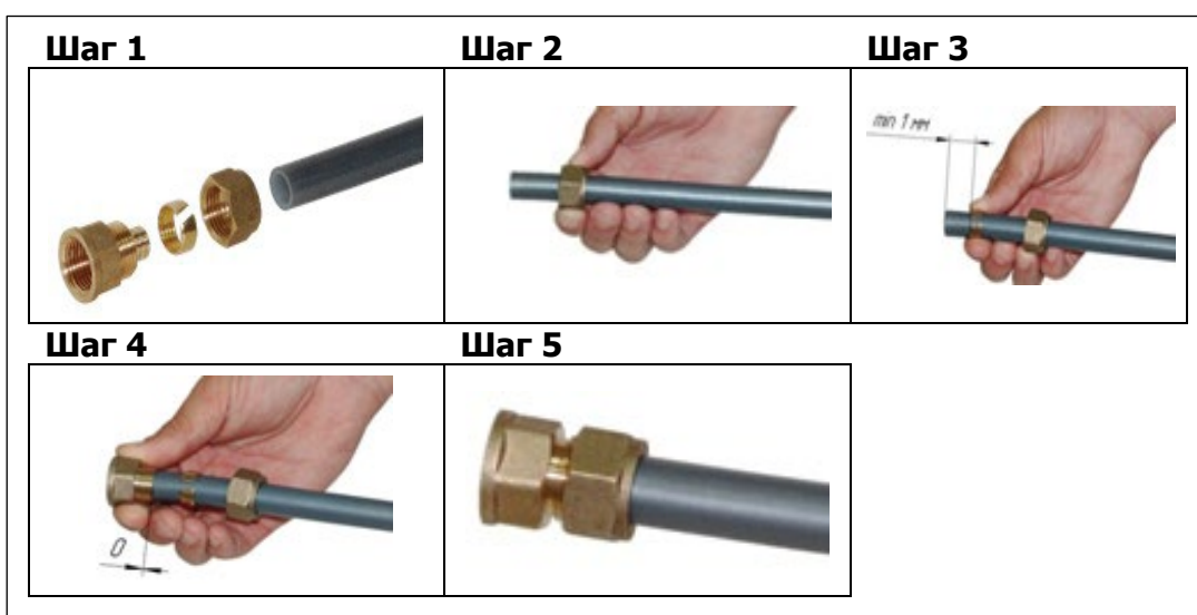
Рисунок 4. Монтаж компрессионного (цангового) фитинга PRADEX FC
